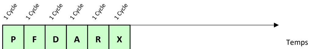
Figure 17 : Représentation temporelle des étapes d'une instruction sans pipeline
